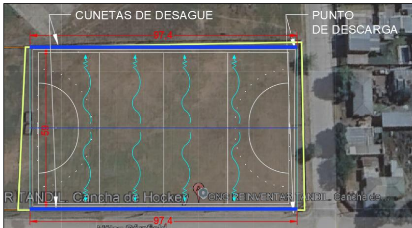
Img. 10 - Ubicación cunetas de desagüe
