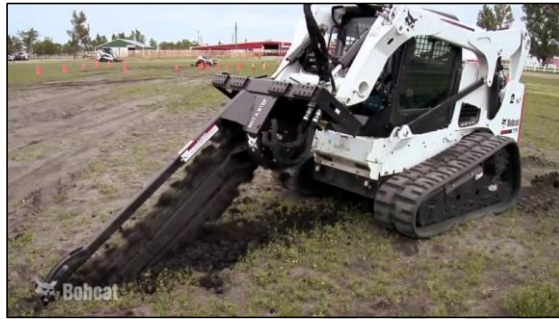
Img. 19 - Minicargadora con accesorio zanjador - Fuente: Develon Chile
